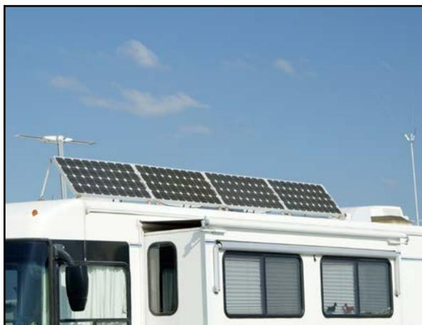
En revanche, pour produire de l'électricité solaire en plein hiver ou avec un rendement plus important, mieux vaut l'installer avec un angle d'inclinaison minimum. Ensuite, à l'intérieur, il suffit de relier le panneau solaire à la batterie de service et de placer, entre les deux, un régulateur de charge et un fusible. Le panneau fournira ainsi directement l'énergie à la batterie.
