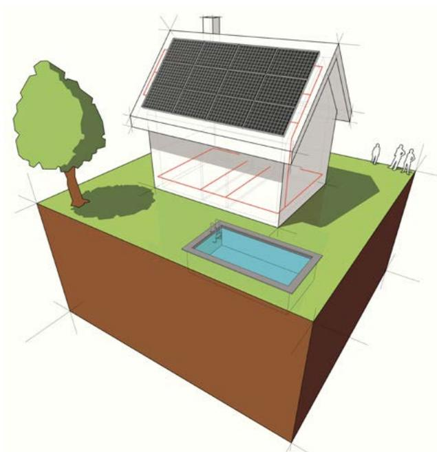
Par ailleurs, pour chauffer une piscine, on prévoit un panneau d'une taille de 25 % à 40 % de la surface de la piscine. Mais cela dépend aussi de la zone d'ensoleillement dans laquelle se trouve votre logement, de la fréquence d'utilisation de la piscine, du type de piscine et de la technologie des capteurs.
