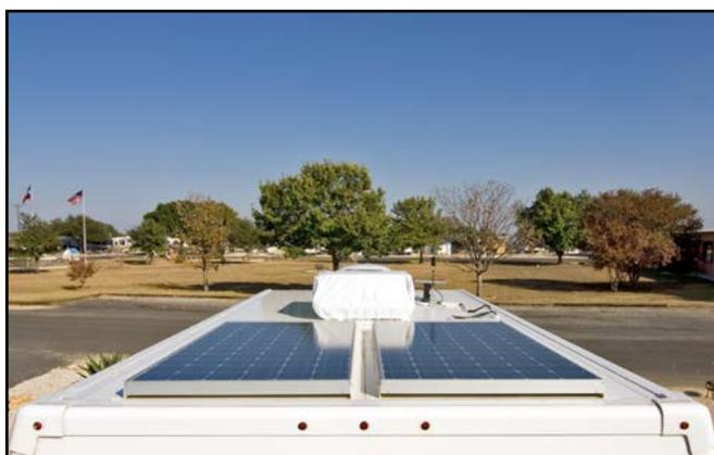
Installer un panneau solaire photovoltaïque sur un camping-car permet de relayer la batterie. Il s'agit plus d'un **système d'appoint** que d'une production principale. Le panneau solaire photovoltaïque permet de produire et d'utiliser l'électricité même à distance d'une prise de courant.
