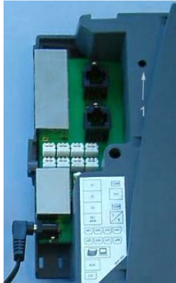
Figure 7-2 : Bouton poussoir pour reconfiguration du PABX
