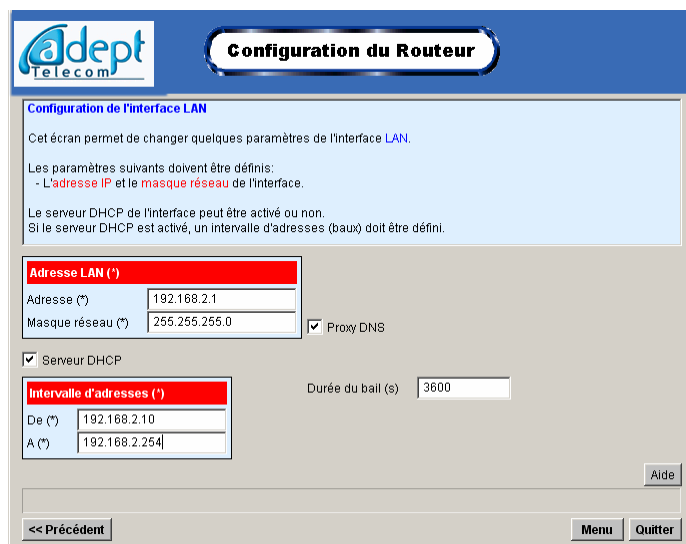
Figure 26-9 : configuration du réseau local du télé-travailleur
