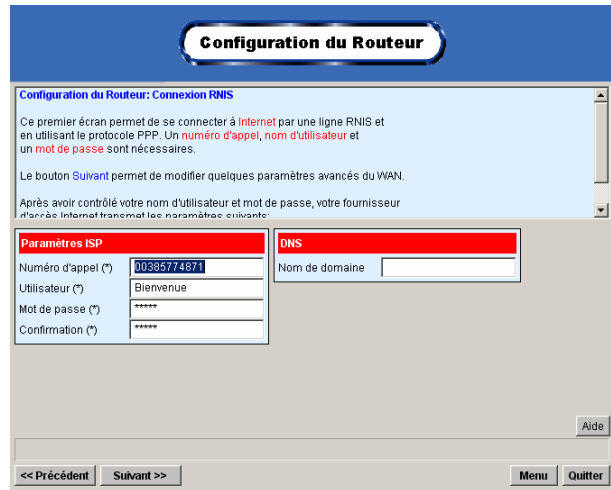
Figure 26-6 : configuration de l'accès distant
