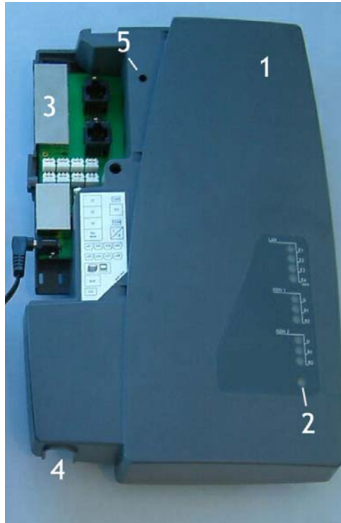
Figure 4-1 : e.Compact trappe ouverte
